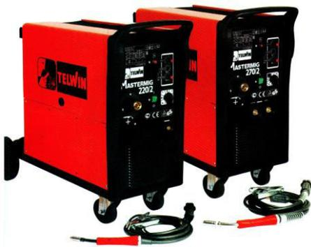
Fahrbare, dreiphasige Schutzgasschweißgeräte mit Ventilator, zum Schweißen nach dem MIG/MAG Verfahren und zum Löten. Geeignet auch für den Endlos- und Punktschweißbetrieb mit elektronischer Regelung der Punktschweißdauer. Flexibles Arbeiten mit verschiedenen Werkstoffen wie Stahl, Edelstahl und Aluminium. Komplett mit Schlauchpaket, Massekabel und Druckminderer.
