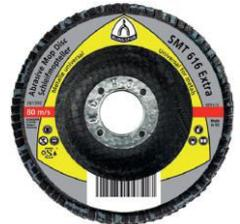
Schleifmopteller für professionellen Einsatz auf Stahl und Edelstahl, Lamellen mit aggressivem Zirkonkorund, flach gewölbte Ausführung, für den Schliff von Kanten und Schweißnähten, auch Plan und Flächenschliff
