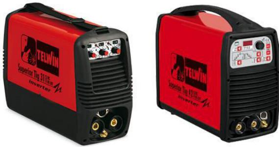
Tragbares, dreiphasiges Inverterschweißgerät mit Ventilator zum Schweißen mit Gleichstrom nach dem WIG- und MMA Verfahren mit HF oder LIFT Zündung. Flexibles Arbeiten mit verschiedenen Materialien wie Stahl, Edelstahl, Titan, Kupfer, Nickel und ihren Legierungen.
