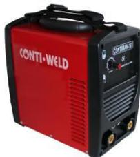
Tragbares, einphasiges Inverterschweißgerät für das Elektrodenschweißen nach dem MMA und WIG Verfahren mit Gleichstrom und Streifenzündung. Flexibler Einsatz verschiedener Elektrodentypen, wie rutile oder basische Elektroden, Edelstahlelektroden, Gusseisenelektroden, usw.
