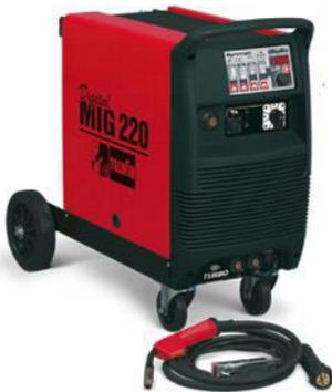
Fahrbares, mikroprozessorgesteuertes Schutzgasschweißgerät mit Ventilator, zum Schweißen nach dem MIG/MAG Verfahren. Besonders geeignet für Arbeiten im Leichtmetall- und Karosseriebau zum Schweißen von verzinkten Blechen, Highstress-Werkstoffen, Edelstahl und Aluminium. Komplett mit Schlauchpaket, Massekabel und Druckminderer.
