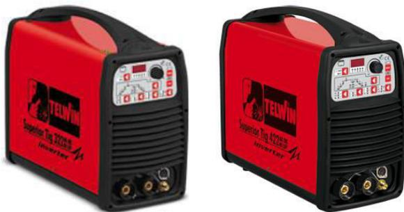
Tragbares, dreiphasiges, mikroprozessor-gesteuertes Inverterschweißgerät mit Ventilator zum Schweißen mit Gleichstrom und Wechselstrom nach dem WIG- und MMA Verfahren, Pulse-WIG, mit HF oder LIFT Zündung. Flexibles Arbeiten mit verschiedenen Materialien wie Stahl, Edelstahl, Aluminium, Titan, Kupfer, Nickel, Magnesium und ihren Legierungen.
